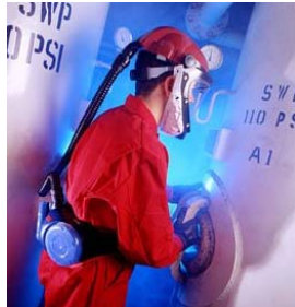
hoofdkap met lokale luchttoevoer via motoraandrijving voorzien van P3-filter
