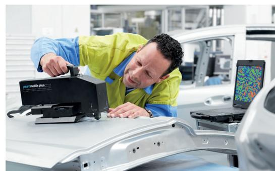
Durch die Messung der Oberflächenrauheit auf einzelnen Bauteilen können anfällige Stellen für Zinkaufschweißungen identifiziert werden
