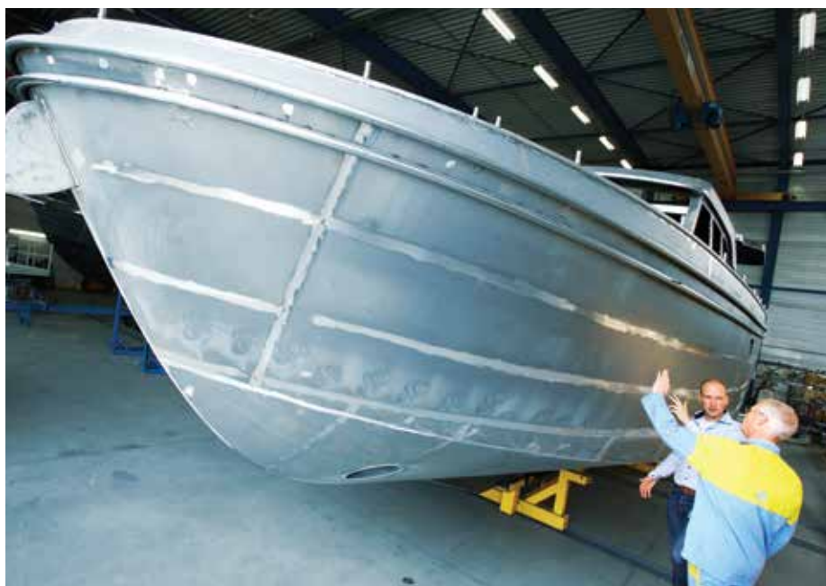
Die Bootsrümpfe der Motoryachten von Linssen Yachts sind dank S235 von Tata Steel besonders glatt.
